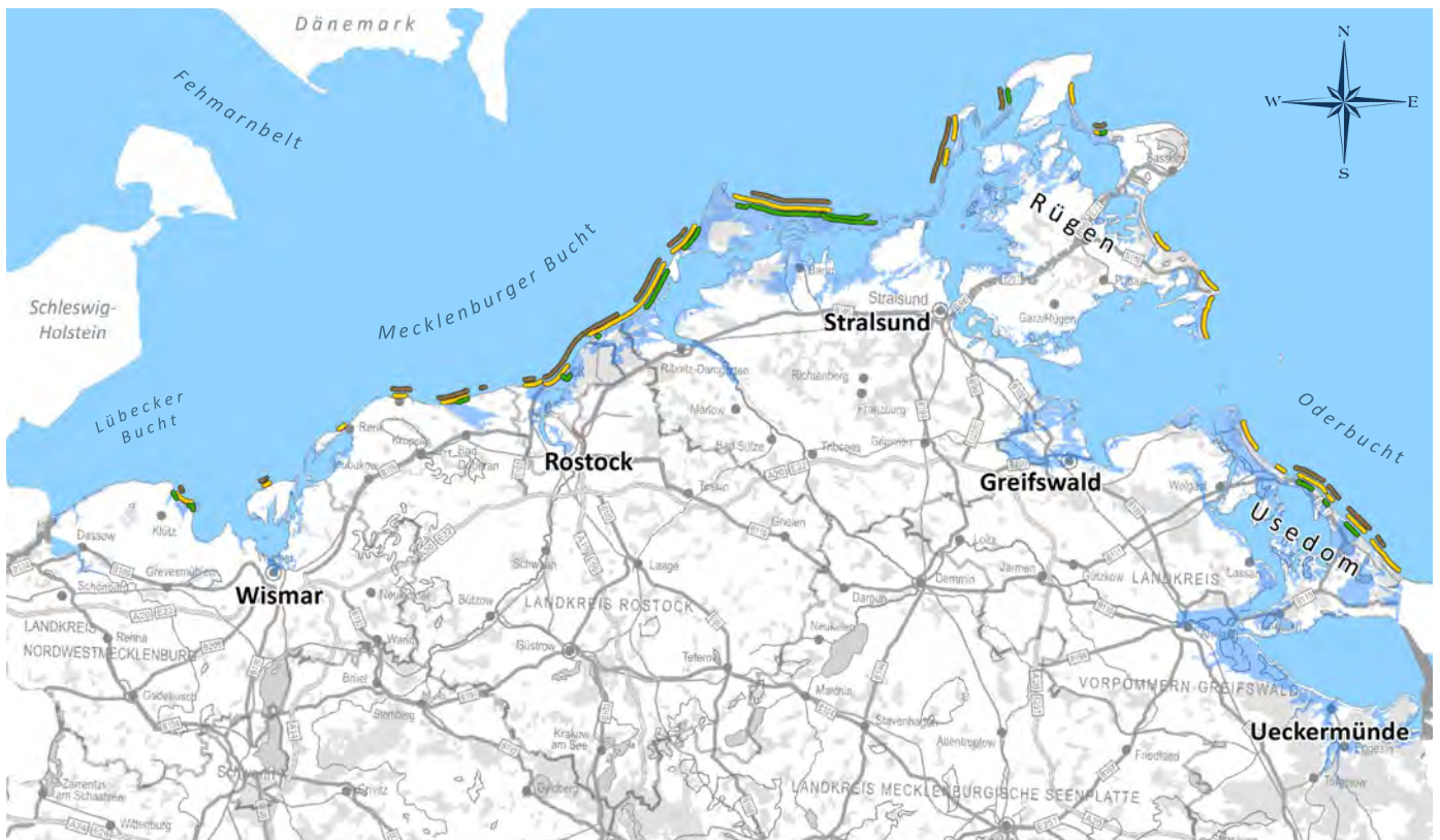
▲ Aktueller Bestand an Küstenschutzanlagen in Mecklenburg-Vorpommern, gelb: 102 km Landesküstenschutzdünen, grün: 54 km Seedeiche, grau: 75 km Buhnsysteme, (Quelle: StALUMM, Abt. Küste).
