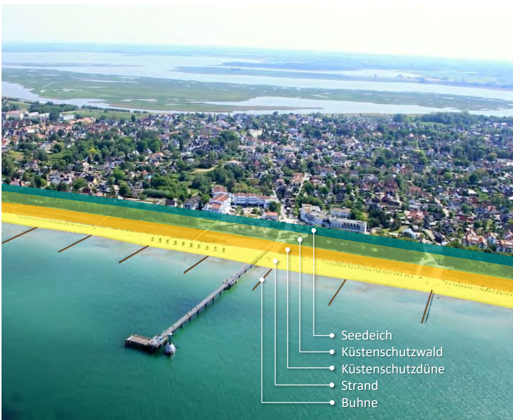
▲ Beispiel eines klassischen Küstenschutzsystems aus Buhnen, Strand, Düne, Küstenschutzwald und Deich. Küstenschutzsystem von Zingst, (Quelle: StALUMM, Abt. Küste).
