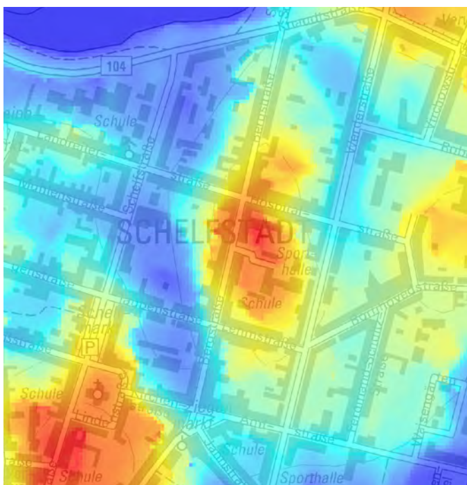
▲ Ausschnitt einer Reliefklassifikationskarte nach dem topographischen Klassifikationsindex für Flachland am Beispiel Schwerin. Blaue Farben kennzeichnen Senken, an die bei Starkregen erhöhte Anforderungen an die Entwässerung gestellt werden. Quelle: LUNG.
